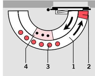
Les deux **vitesse de fermeture indépendantes** du TS 91 se règlent en continu par deux valves hydrauliques frontales. Sur le TS 91, la **force de fermeture** est fixe EN 3.
