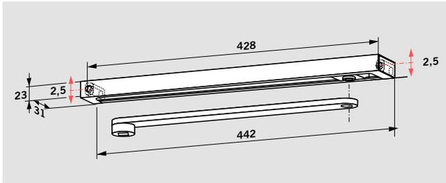
La glissière **G-N** comprend: le bras, la glissière, le coulisseau, les éléments de fixation, les vis et les caches. Elle est réversible droite / gauche et s'adapte à l'ensemble de la gamme Contur, TS 91, TS 92, TS 93.
