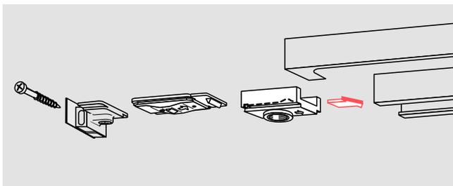
Le dispositif d'arrêt **RF** permet un maintien en position d'ouverture de la porte. Le point d'arrêt en position d'ouverture est réglable à volonté par vis entre 75° et 150° environ.
