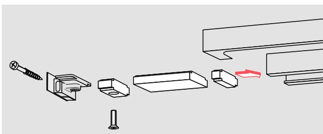
Le limiteur d'ouverture avec amortissement progressif s'intègre en option dans la glissière. Réglable entre 80° et 120° maximum. Ce dispositif permet de protéger porte et cloison, en cas d'utilisation anormale de la porte.
